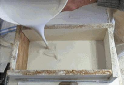
2. Ist die Schalung einmal gefüllt, sollte das ganze Konstrukt sanft vibriert werden um sicher zu gehen, dass sich die Gipsmasse in alle Winkel verteilt und alle noch eingeschlossenen Luftblasen an die Oberfläche kommen. Die beste Art und Weise dies zu machen, ist es , während ca. 5 Minuten sanft auf die Unterlage auf dem das Modell steht zu hämmern (zum Beispiel Tischplatte). Dabei sollte wirklich sanft vibriert werden, damit sich keine Teile in der Schalung verschieben oder ablösen.
