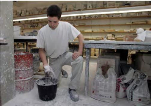
3. Soll der Gips mit Pigmenten gefärbt werden, dann diese ins Gipspulver VOR dem Einstreuen ins Wasser mischen. **WICHTIG:** Es braucht erhebliche Mengen Pigmente um eine Farbintensität höher als Pastell zu erhalten. Das Weiss des Gipspulvers dämpft jedes Pigment sehr stark ab.
